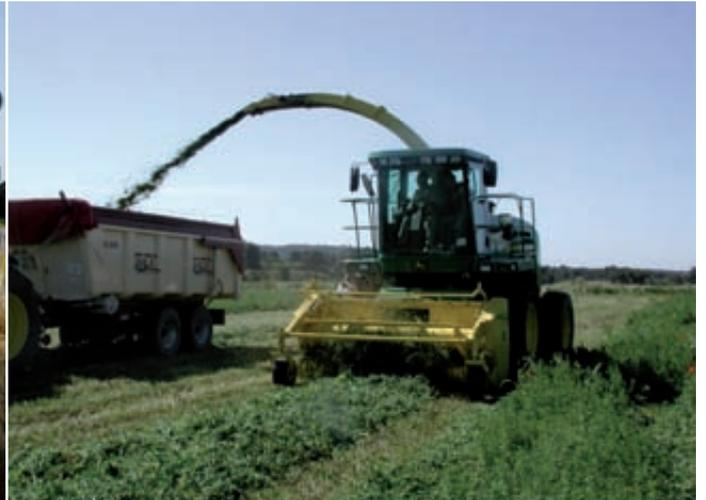
Foto 8. Cosechadora de forraje autopropulsada con cabezal de recogida.
