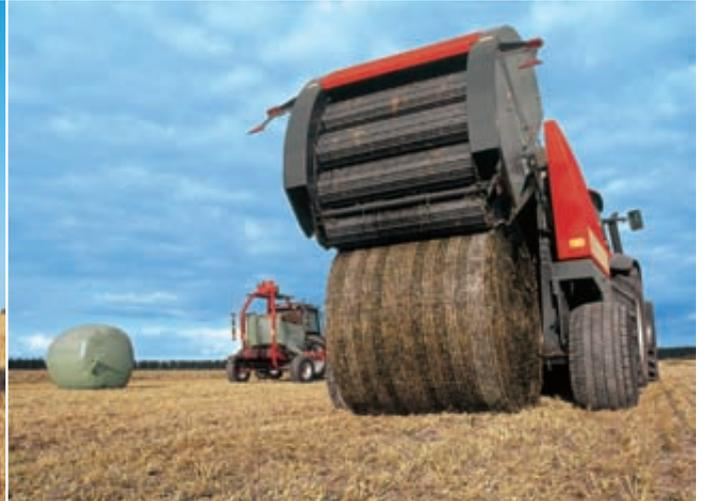
Foto 6. Rotoempacadora de cámara fija.
