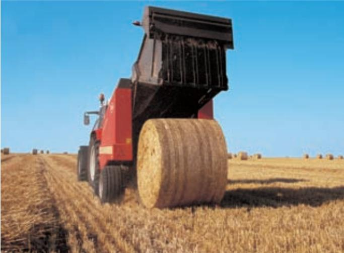
Foto 5. Rotoempacadora de cámara variable.
