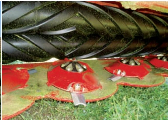
Foto 2. Segadora acondicionadora de rodillos de caucho acanalados.
