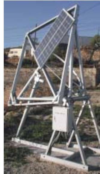
El seguidor solar de dos ejes permite realizar el seguimiento del sol desde el orto hasta el ocaso.
