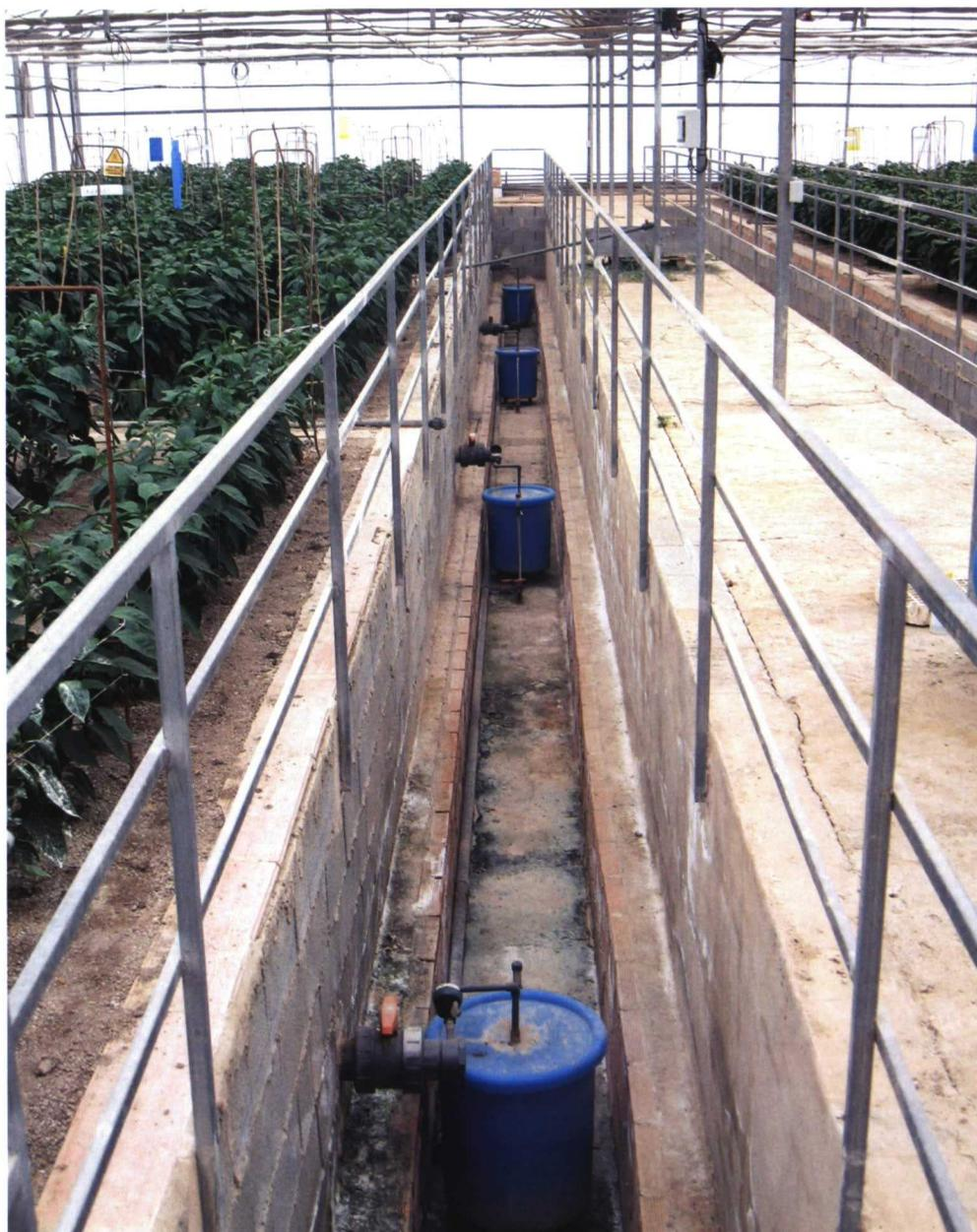
**La infraestructura fundamental del ensayo es un conjunto de ocho lisímetros de drenaje de 7,80 x 6,65 m<sup>2</sup> cada uno.**
