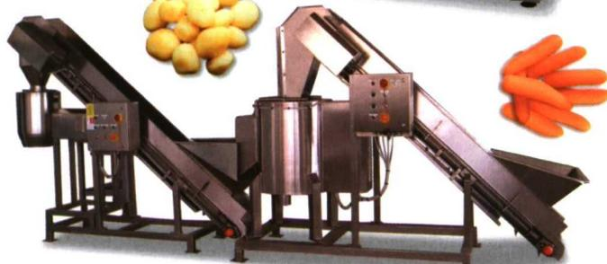
Línea monobloque de pelado y corte de patatas y zanahoria
