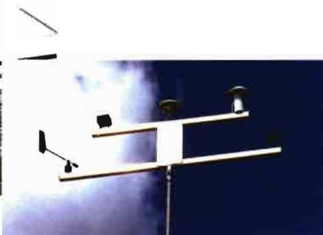
Formadas por un brazo que gira sobre un eje vertical al que se incorpora un deflector. Cuando existe una corriente de aire, el viento ejerce una presión sobre el deflector que hace que el brazo gire y el extremo señale la dirección de donde procede el viento.
