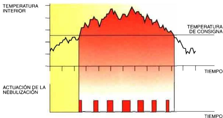
**Gráfico 4. Los sistemas de nebulización pueden funcionar cíclicamente en periodos prefijados. También pueden controlarse en función de la temperatura con control proporcional, como en este ejemplo. A medida que la temperatura en el invernadero aumenta, la nebulización funciona durante más tiempo en cada ciclo, emitiendo más agua.**
