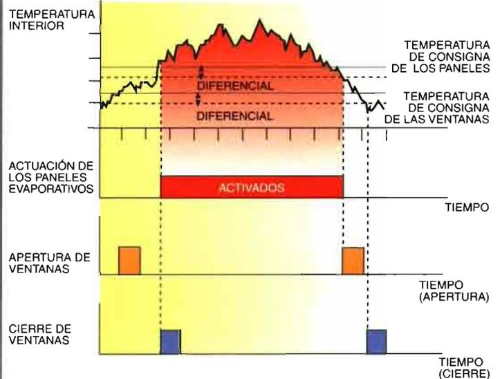
Gráfico 5: Ejemplo de control de ventanas y paneles evaporativos. A medida que aumenta la temperatura, sucesivamente se abren las ventanas y arranca el sistema de paneles. Cuando el sistema evaporativo funciona, las ventanas se cierran, para que el aire fresco producido realice el recorrido óptimo por el invernadero.
