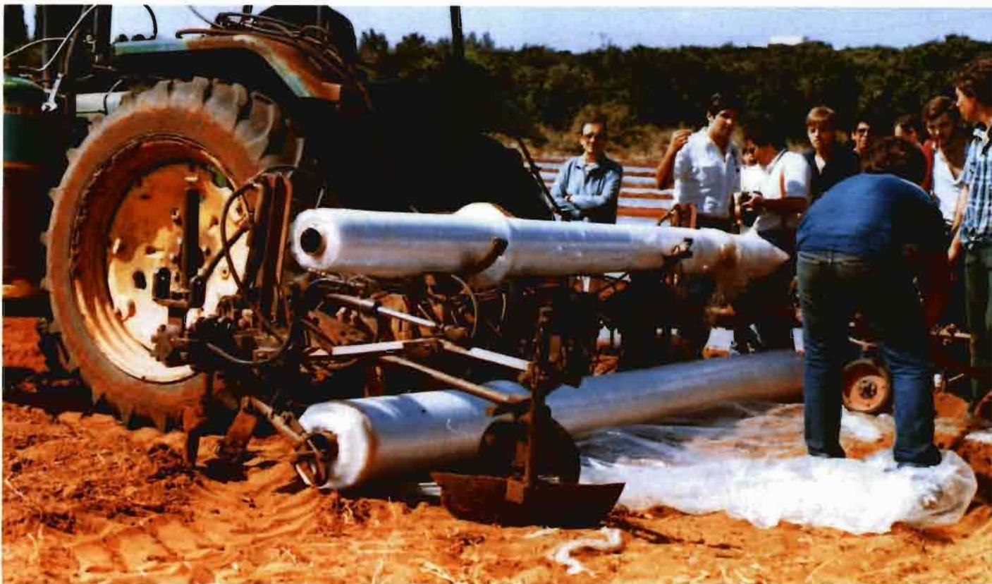
Una imagen prácticamente irrepetible. Preparación del plástico en el terreno para la aplicación del bromuro de metilo. Foto: Tecniplant.
