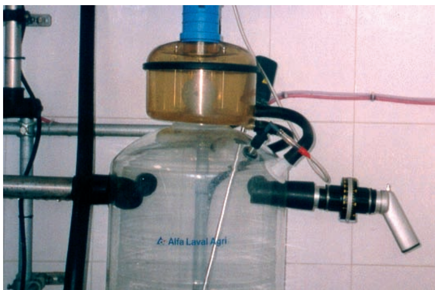
Comprobación de la reserva de vacío en A1
