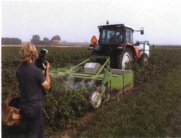
Foto 3: Piroescardador acoplado al tractor para el control de las hierbas, por ejemplo para el secado de las plantas en el cultivo de patata con placa calefactora que transmite el calor con rayos infrarrojos.
