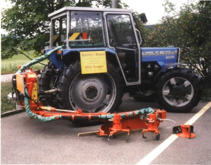
Foto 7: Desbrozadora de dos cuerpos con sensor de desplazamiento diseñada para realizar una labor superficial bajo las filas de frutales (modelo Santini und Braun)
