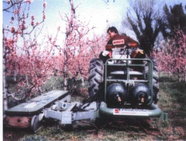
Foto 4: Termodesherbador acoplado al tractor en una plantación de frutales.
