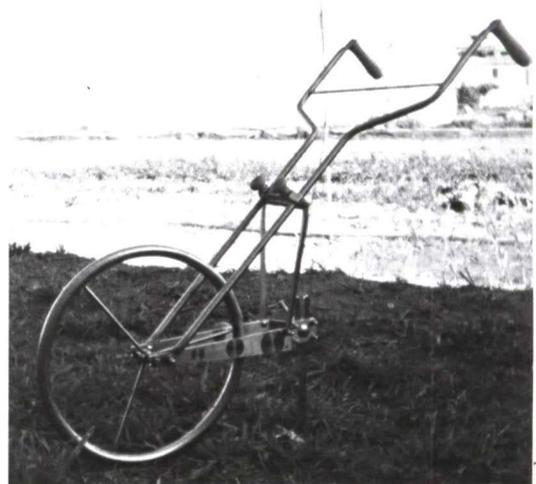
Foto 1: Portaaperos con rueda de bicicleta para aporcar, entrecavar o binar la hierba en las entrelíneas de un huerto
