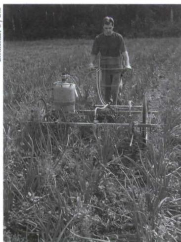
Foto 2: Portaaperos con dos ruedas de bicicleta para aporcar, entrecavar, realizar un desherbado térmico o cortar la hierba en varias entrelíneas
