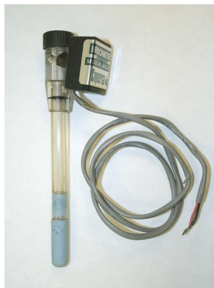
Figura 4b. Electrotensiómetro para cultivo en contenedor.
