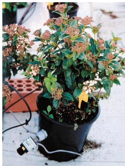
Figura 4a. Colocación de un electro tensiómetro en el contenedor
