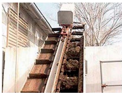
Figura 6: Transportador exterior (rampa de elevación).
