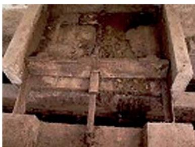
Figura 3: Pala de limpieza fija
