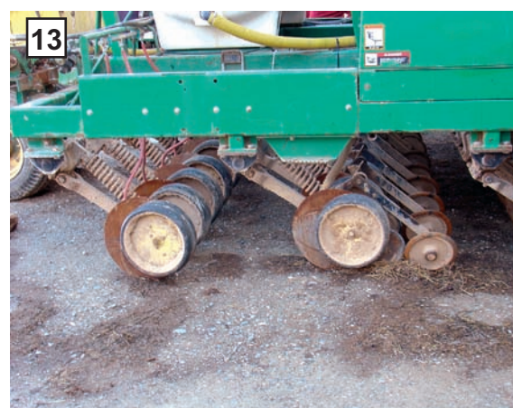
13 Sistema de inyección de abono líquido con sistema de apertura propio previo al tren de siembra
