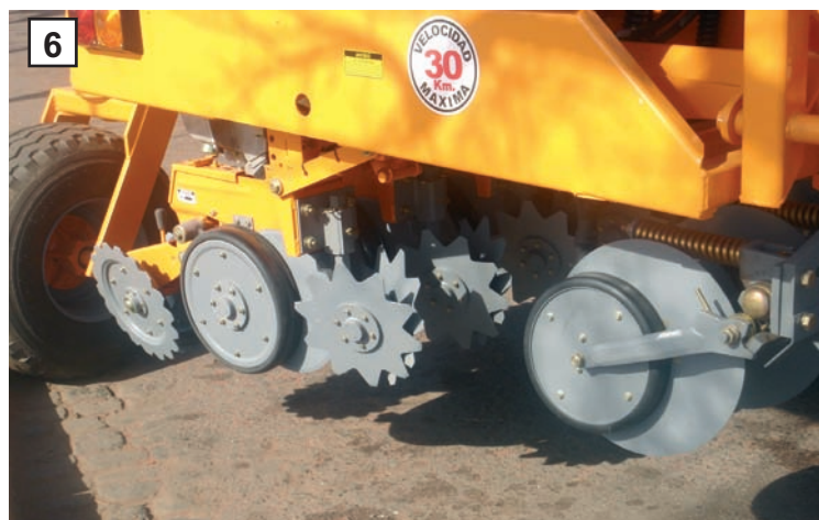
Tren de siembra con disco de corte del residuo y estrellas de limpieza del surco de siembra
