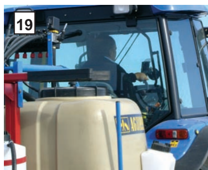
Tractor con sistema de ayuda al guiado mediante GPS y PDA en una aplicación de herbicida
