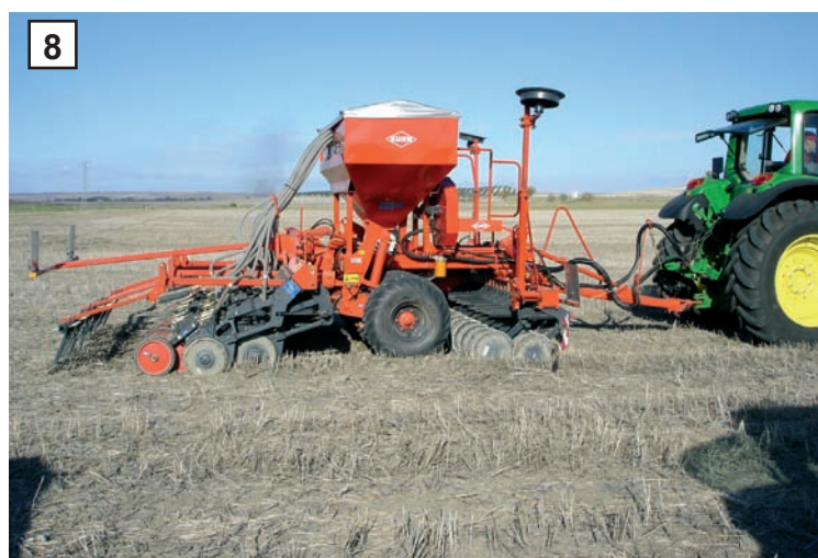
Sembradora directa neumática de disco de apertura doble
