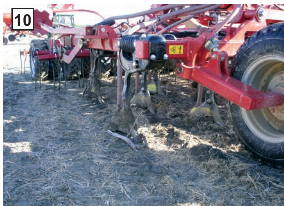
10 Sembradora directa neumática de reja con ruedas de cierre de surco
