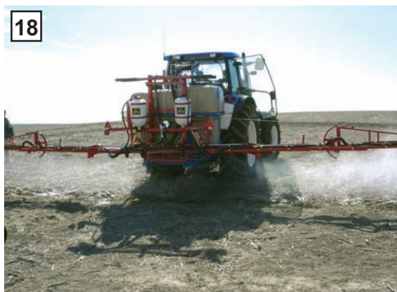
Barra de tratamientos con boquillas antideriva (derecha) y normales (izquierda)
