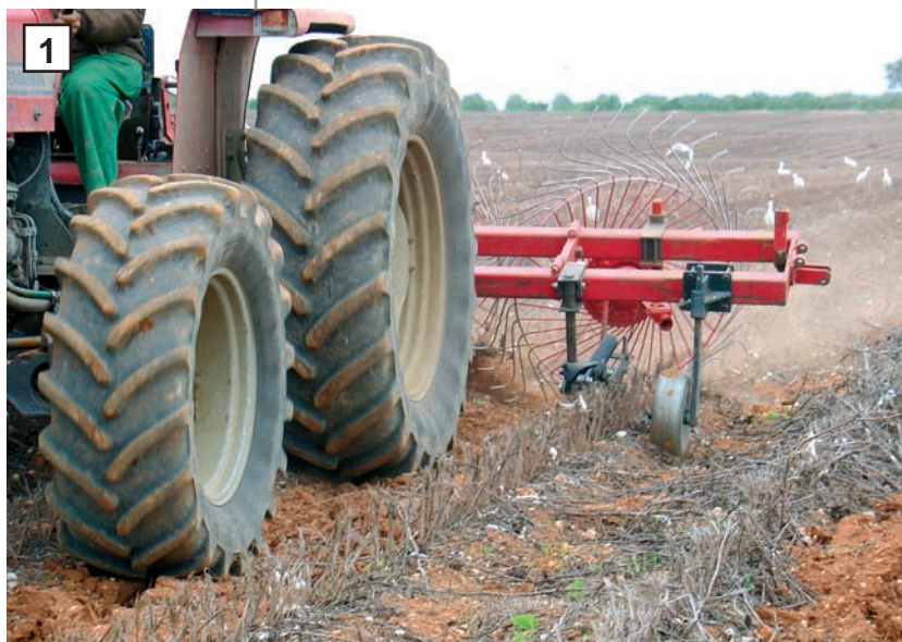
Tractor con ruedas de baja presión en labor de limpieza de la línea de siembra de restos de algodón para la siembra de maíz
