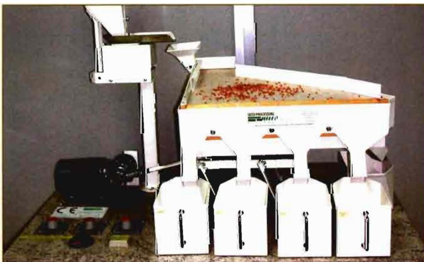
Figura 5. Mesa densimétrica. La separación en fracciones de una muestra depende de la cantidad de aire que se aplica sobre el material, de la inclinación de la mesa y de la velocidad de vibración de la misma.
