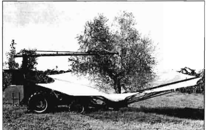
Acoplamiento del «paraguas invertido» (receptor de aceitunas) al vibrador, en este caso de ramas (derribo de aceitunas). Italia, 1975.
