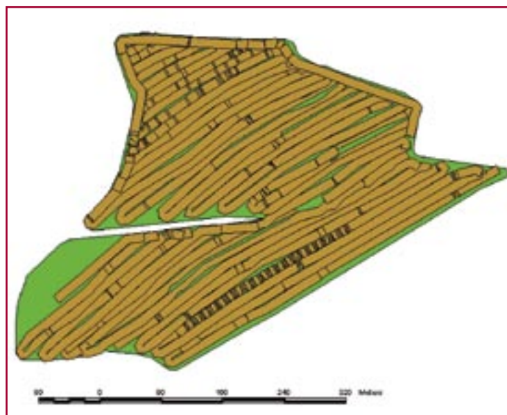
Figura 7. Mapa de aplicación con guiado manual mostrando huecos y solapes.
