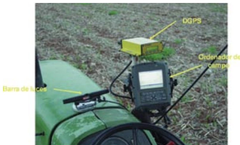
Figura 8. Sistema de ayuda al guiado (barra de luces).
