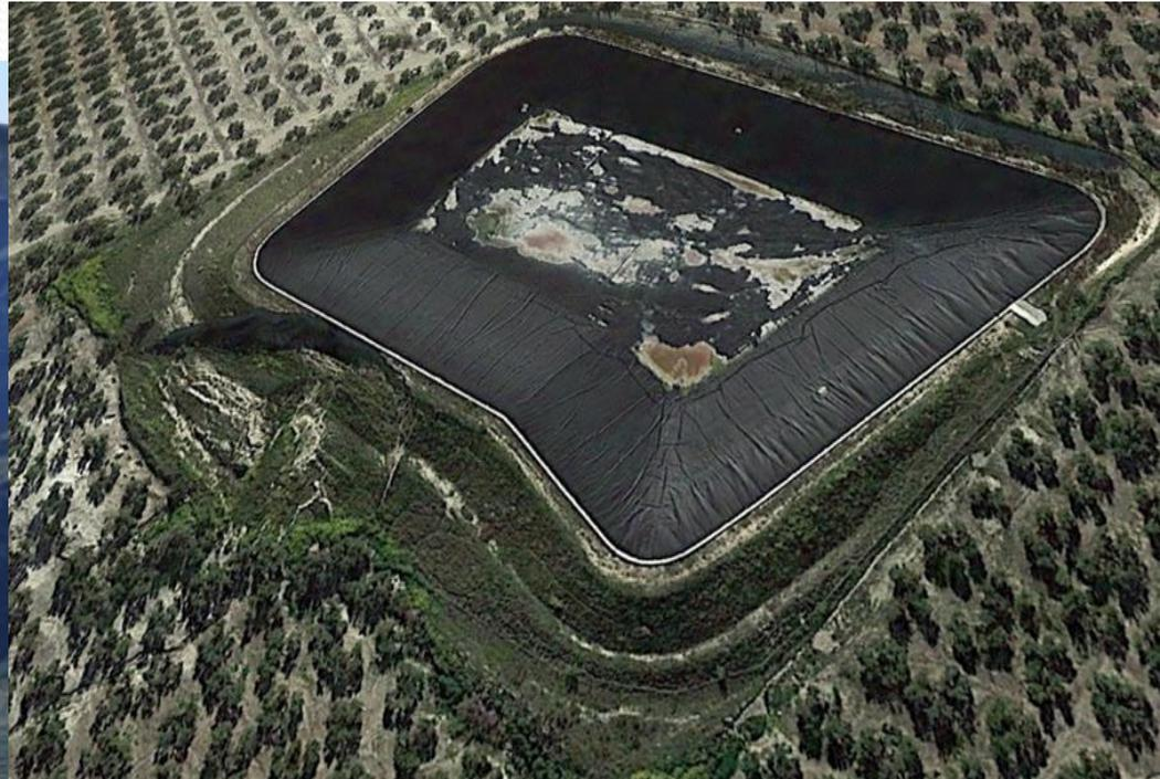
**AL TERCER AÑO DE FUNCIONAMIENTO SUFRIÓ UN DESLIZAMIENTO DEL DIQUE**
