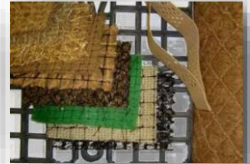
Material de Control de Erosión
