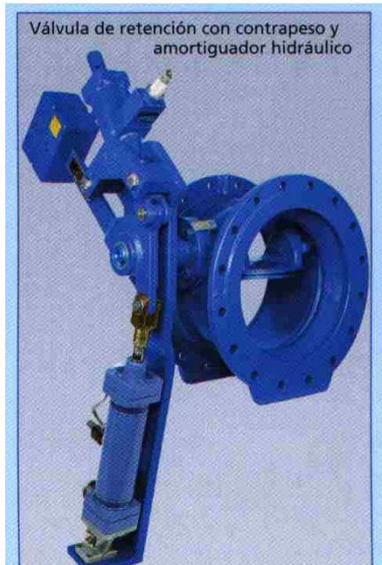
MARIPOSA CON CONTRAPESO Y AMORTIGUADOR. REGULADOR DE LAS VELOCIDADES DE APERTURA Y CIERRE
