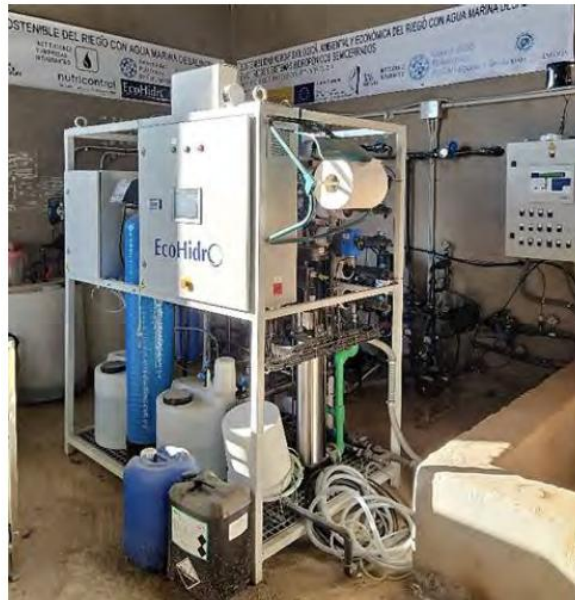
Figura 1. Equipo de reducción de boro en el agua de riego basado en la implementación de membranas de osmosis inversa (izquierda: parte frontal;
