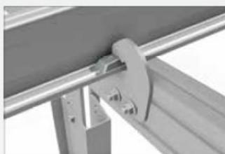
A diferencia del sistema en huertas solares FS (aluminio), los perfiles portantes de módulos no son fijados a los kits de montaje para vigueta mediante garras de montaje. En el caso de la estructura de acero, hay ganchos especiales de empalme, premontados en los kits de montaje para vigueta, en los cuales son introducidos mediante un giro los perfiles portantes de módulos. Para fijar los perfiles portantes de módulos se embuten dispositivos tensores con un martillo de caucho.
