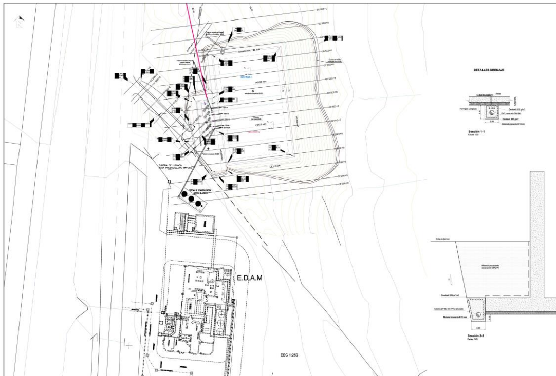
Figura 6. Detalle en planta de la estación desaladora y de la situación del depósito de agua producto asociado. Plano del proyecto de la EDAM.
