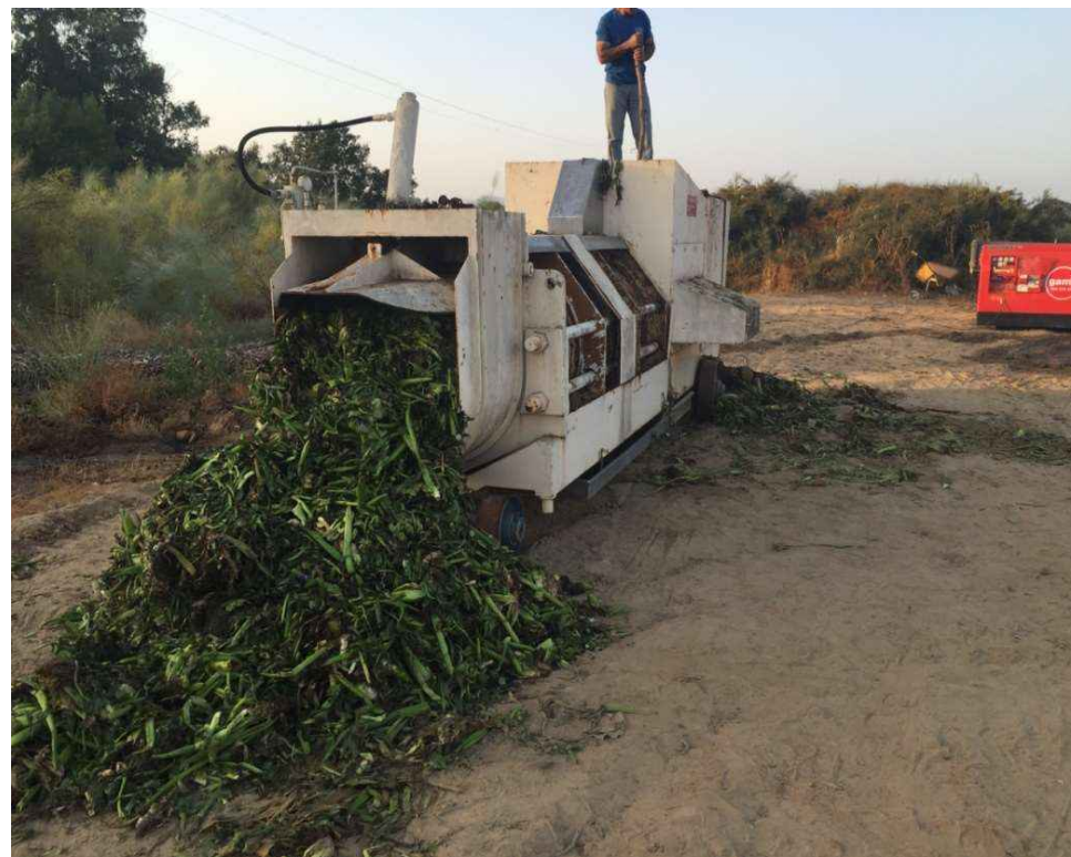
Trituración mediante maquina tornillo sin-fin
