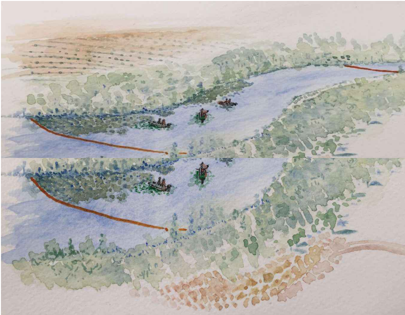
Extracción manual desde embarcaciones y barreras de control
