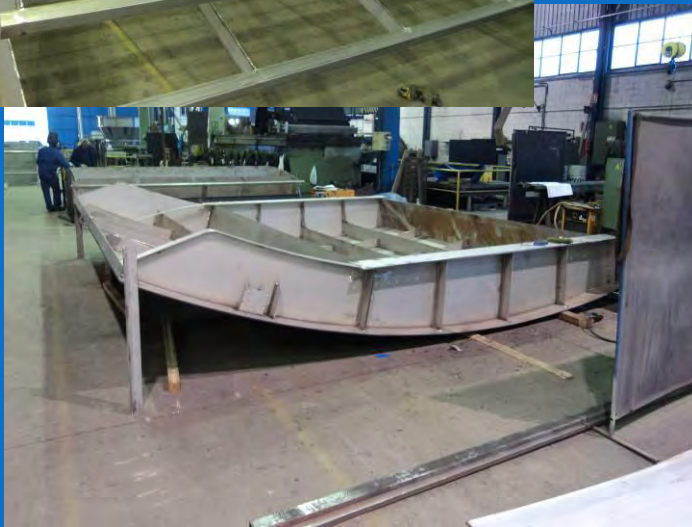
COMPUERTA CON EL TABLERO
