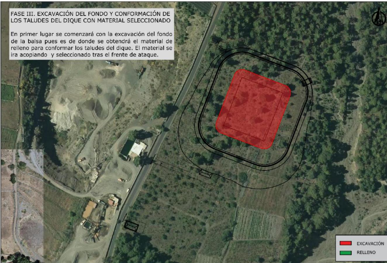
**FASE III. EXCAVACIÓN DEL FONDO Y CONFORMACIÓN DE LOS TALUDES DEL DIQUE CON MATERIAL SELECCIONADO**
