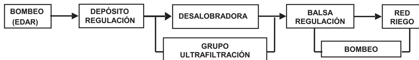
**Depósito de regulación.**—El depósito de 60 m<sup>3</sup> de capacidad se localiza entre la estación depuradora y la planta desalobradoradora. Su función es regular los posibles picos horarios de volumen entrante a la desalobradoradora.
