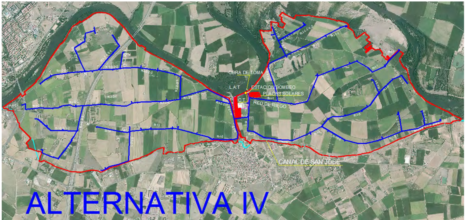
Mapa 9.- Alternativa IV: Riego del SI del Canal de San José con bombeo directo desde Azud de Villaralbo. Opción de Red II.
