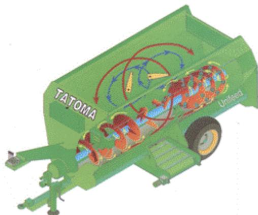
Mezclador-picador de pequeña capacidad para el tripuntal del tractor
