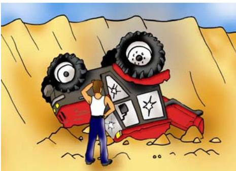
Para evitar el aplastamiento en caso de vuelco, el tractor debe llevar una estructura de protección
