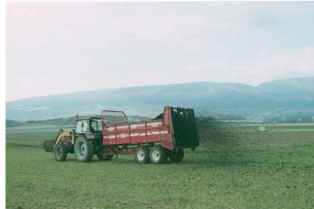
Figura 4. Sistema de aplicación de deyecciones mediante esparcido.
