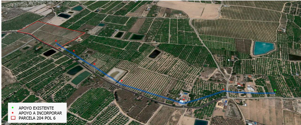
**Figura 5: Construcción de línea AT desde apoyo existente hacia parcela 204 del polígono 6, para dar servicio al bombeo.**
