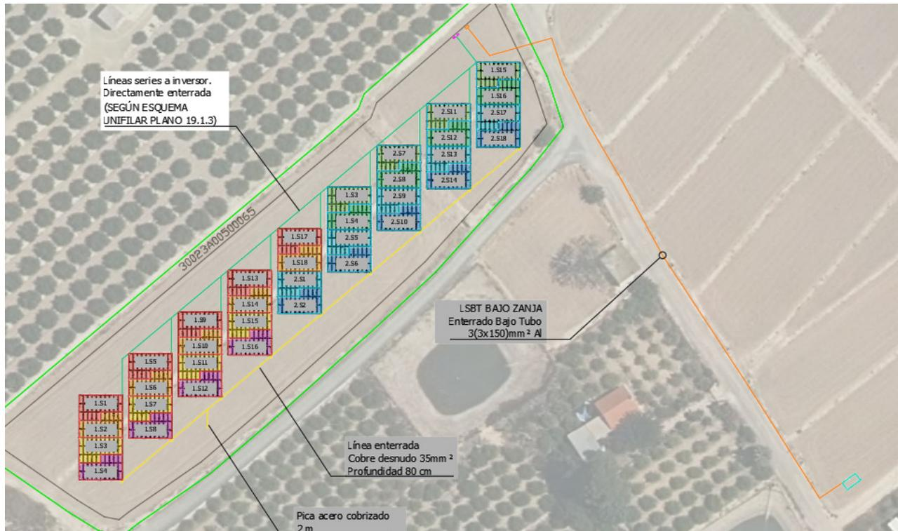
**Figura 7: Planta general de la instalación fotovoltaica proyectada para la estación de bombeo**
