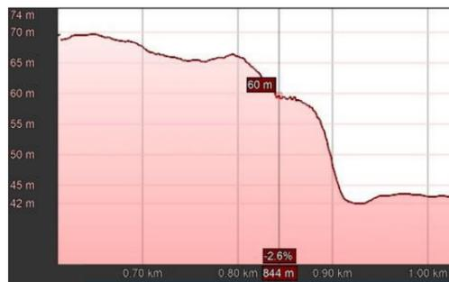
Como se puede observar, existe un desnivel de hasta 20 m. Se pretende resolver dicho desnivel con un terraplén que en coronación permita el descenso gradual de la conducción y la colocación de un camino de mantenimiento.
