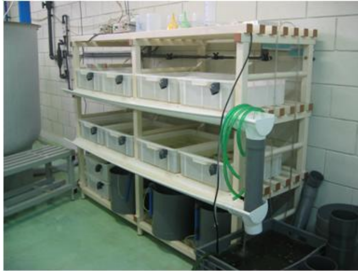
Figura 1. Detalle del circuito de acondicionamiento de reproductores de almeja.
