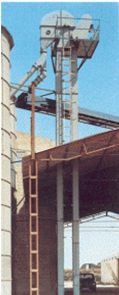
Transportador de cadenas situado en la parte superior de un silo
