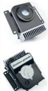
La integración del sensor NIR permite el análisis, registro y mapeo de la composición de la cosecha durante la recolección. El funcionamiento se basa en la medida de la absorción de radiación electromagnética (radiación infrarroja cercana).
