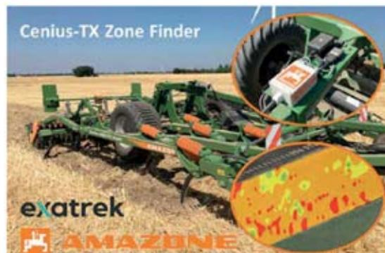
En opinión del Jurado *“el sistema no utiliza ningún dispositivo de medición adicional, solo utiliza e interactúa con los datos medidos por sensores presentes de serie en la mayoría de los tractores, y las mediciones se realizan durante la etapa de labranza.”*
