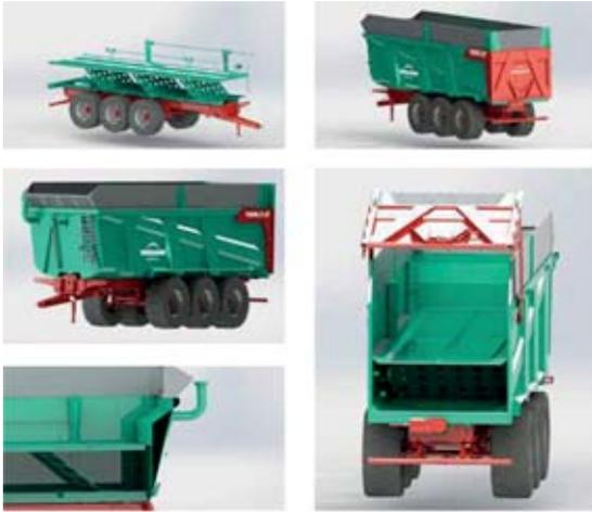
El Jurado destaca que *“el volquete evita el transporte en vacío en determinadas aplicaciones, como para la alimentación de instalaciones de metanización con materia orgánica seca y retorno con una carga de digestato.”*
