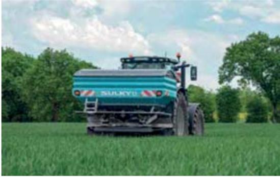
La velocidad de desplazamiento de la abonadora influye en el perfil de distribución de abono, y esto se manifiesta más intensamente a medida que aumenta la velocidad de trabajo en campo. Sulky ha desarrollado una tecnología que permite adaptar el esparcido de abono a la velocidad de avance de la abonadora.
