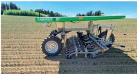
Este robot permite sembrar y a la vez realizar el control mecánico de las malas hierbas entre plantas y en la interfila. Al contrario de otros sistemas, no utiliza cámaras para determinar la posición de la maleza, sino que actúa a partir de posición de cada semilla marcada con tecnología GPS de muy alta precisión.
