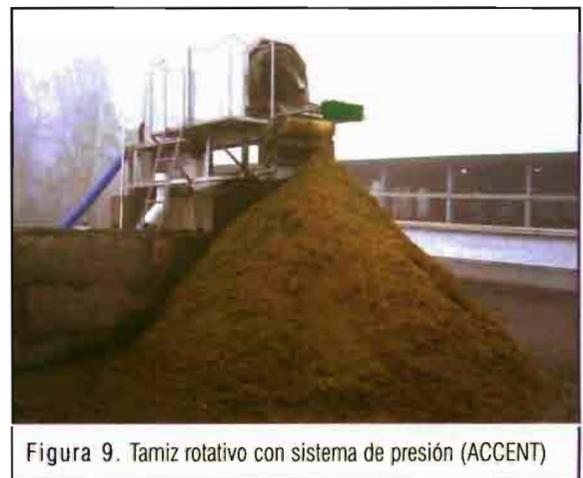
Figura 9. Tamiz rotativo con sistema de presión (ACCENT)
