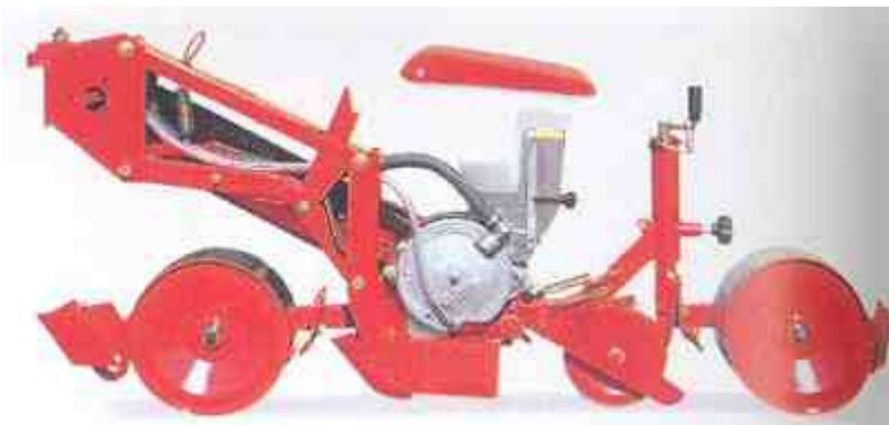
Sembradora de hortalizas con dosificador neumático
