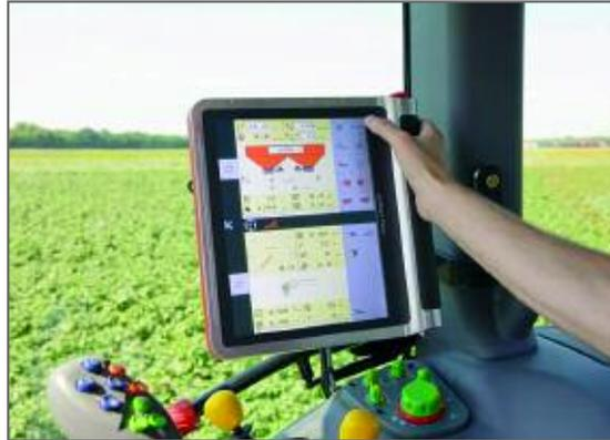
**Keverneland Group**, por la Consola ISO-BUS de doble pantalla, que le permite manejar dos implementos ISO-BUS simultáneamente. Utiliza una doble pantalla de 12.1 pulgadas, con teclado virtual alfanumérico y software actualizable por Internet; dispone, además de la conexión ISO-BUS, cuatro terminales USB, una RS230, entradas y salidas de audio para micrófonos y auriculares, conexión de cámaras con hasta cuatro pantallas con multiplex y conector RJ45 Ethernet.
