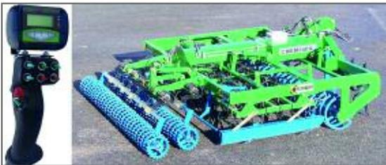
**Franquet**, por el sistema electrónico de control de un equipo de preparación del lecho de siembra, con el que se puede modificar la profundidad de trabajo de las púas, la posición de la placa niveladora, y la presión de los rodillos asentadores desde la cabina, manteniendo siempre la horizontalidad del conjunto.
