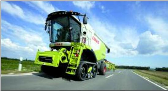
ros permite circular a velocidades de hasta 40 km/h, con solo una anchura total de 3.50 m. La utilización de las bandas de goma ayuda a reducir la compactación del suelo, a la vez que proporciona gran confort de marcha.
