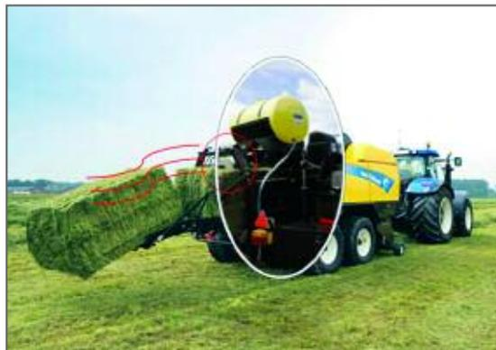
**New Holland**, por su sistema Crop ID para el etiquetado de pacas formadas por empacadoras de alta densidad, unido al sistema de pesado de la paca. La etiqueta se fija sobre el hilo de la paca a la altura del nudo, y las informaciones sobre la misma se realizan mediante la utilización de una frecuencia de radio y un emisor. Las in-
