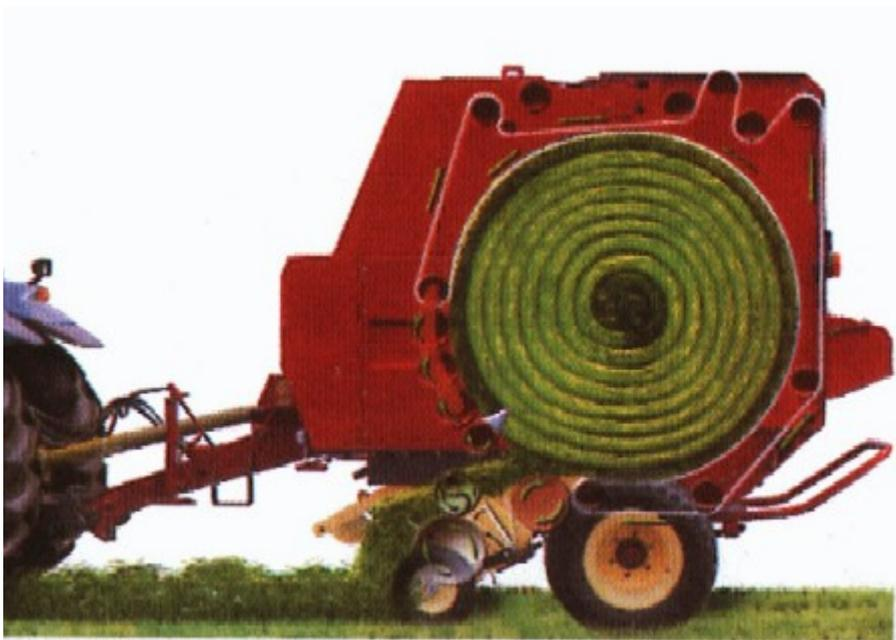
Rotoempacadora de cámara variable con correas (apertura para descarga de paca)
