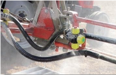
El abanico de distribución de las boquillas es interceptado por algún elemento de la barra afectando gravemente a la uniformidad de distribución
