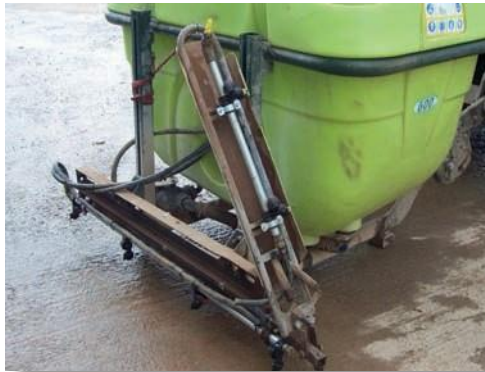
Dispositivo de vaciado de difícil acceso y con riesgo de contaminación del operario al accionarlo
