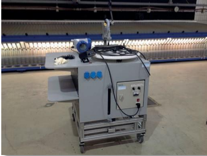
Equipo para la determinación del caudal de las boquillas retiradas de la barra de pulverización
