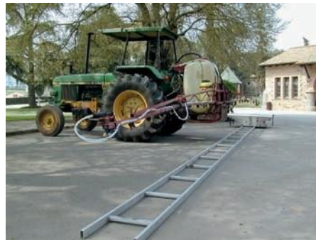
La barra no presenta la estabilidad necesaria. Alguno de los tramos no mantiene su posición
