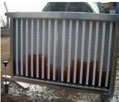
La evaluación de los caudales de las boquillas en un pulverizador debe realizarse por grupos de boquillas de igual calibre
