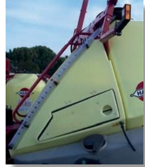
Indicador de nivel correcto y visible desde el punto de conducción y/o desde el punto de llenado
