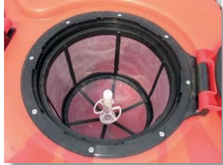
Estado correcto del filtro de llenado
