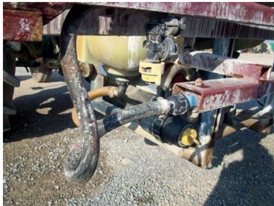
El abanico de distribución de las boquillas es interceptado por algún elemento de la barra afectando gravemente a la uniformidad de distribución
