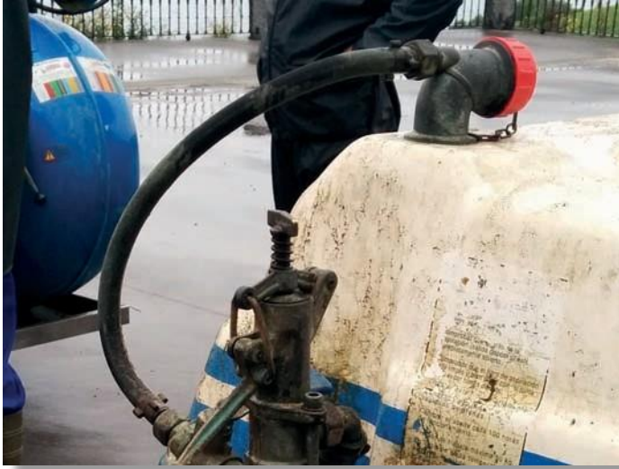
El sistema de carga del depósito está provisto de un sistema anti retorno que evita el riesgo de contaminación
