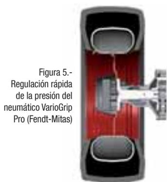
Para evitarlo se ha presentado una nueva opción (VarioGrip Pro, Fendt-Mitas), con una cámara especial en el interior de la cubierta, de menor volumen y que se infla a mayor presión. El sistema es capaz de aumentar 1 bar la presión de los neumáticos en sólo 30 segundos, 15 veces más rápido que utilizando el neumático convencional sin cámara interior (Figura 5).
