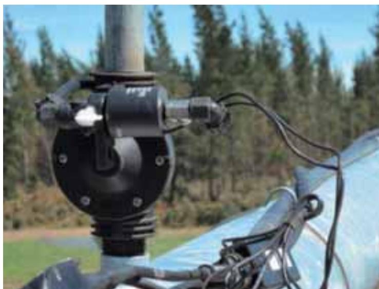
Figura 9.- Sistema Irrigate+IQ de Trimble que mantiene la presión regulada en el pivot.
