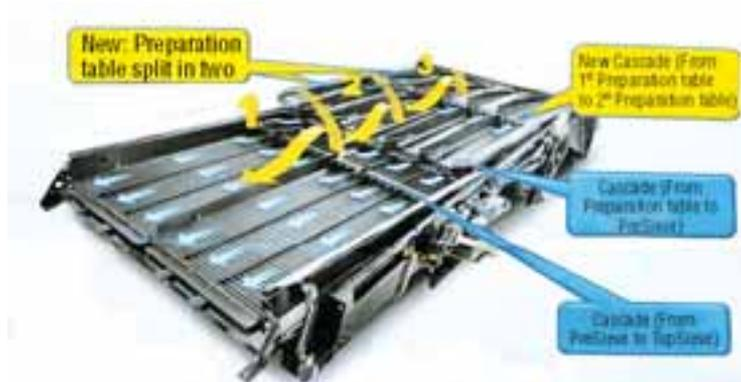
Figura 6.- Cajón de cribas Triple-Clean de New Holland.
