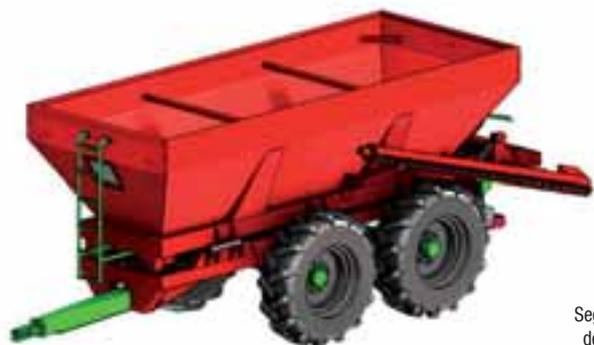
Figura 7.- Abonadora Segués con doble sistema de proyección del abono.
