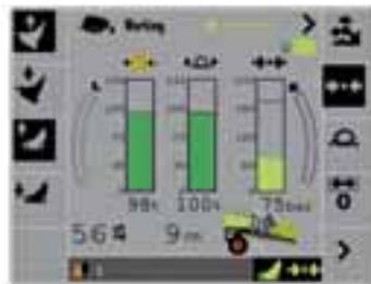
Figura 13.- Sistema APC de Claas para la regulación automática de la presión de empacado
