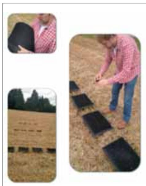
Figura 6.- Sistema de recogida de granulos con alfombras y calibración en campo de las abonadoras Amzone EasyCheck.
