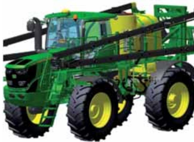
Figura 2.- Barras de pulverización ultraligeras de fibra de carbono de John Deere.
