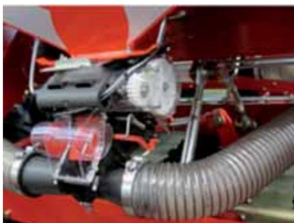
Figura 4.- Dosificador electrónico para las sembradoras de cereales Kverneland.
