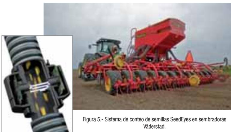
Figura 5.- Sistema de conteo de semillas SeedEyes en sembradoras Väderstad.
