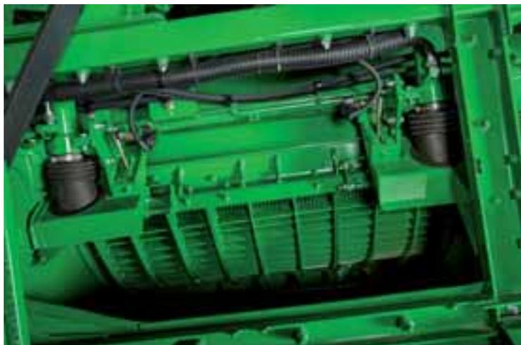
Figura 5.- Sistema de ajuste activo del cóncavo (ACI) de John Deere.
