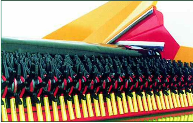
Limpieza mediante estrellas en rotación.
