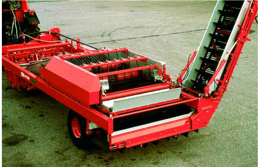
Cosechadora arrastrada de dos líneas con descarga sobre remolque.
