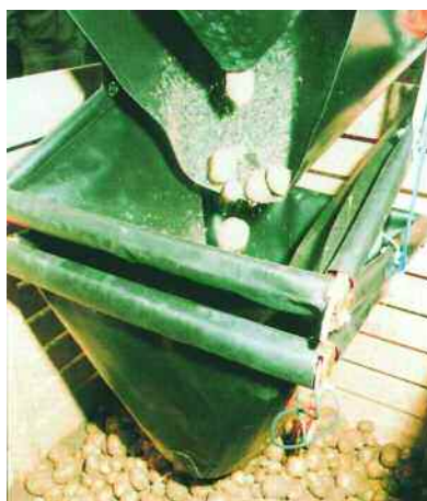
Amortiguador de choque en la caída.
