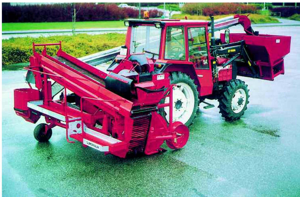
Cosechadora de una línea integrada en el tractor.
