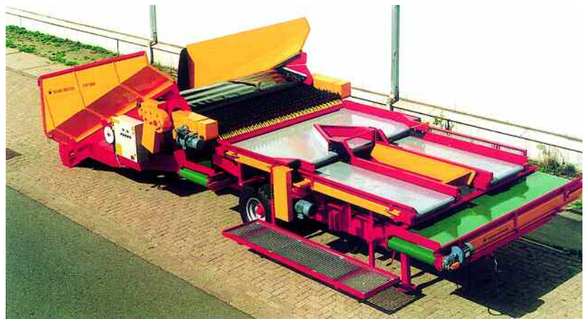
Unidad combinada con recepción, limpieza e inspección.
