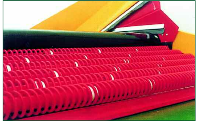
Limpieza mediante rodillos en rotación.
