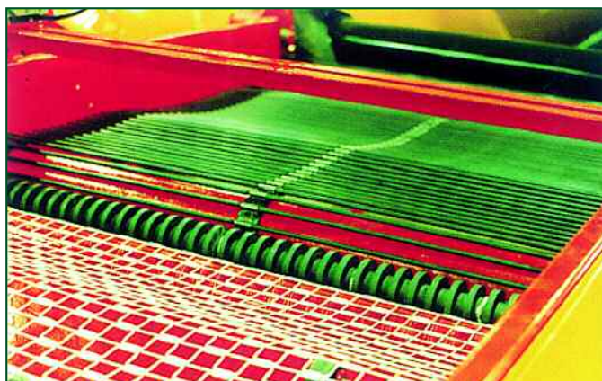
Preclasificación: esteras y cadena de criba.
