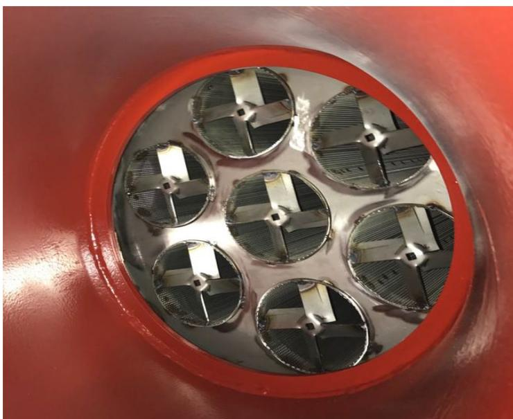
**Figura 22.** Multihélice fija a entrada del filtro
