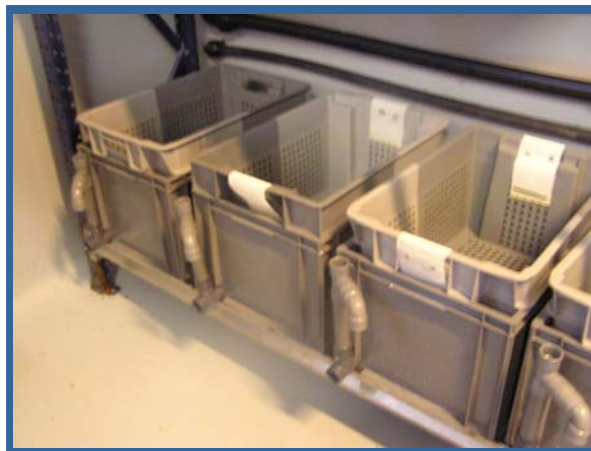
Figura 58. Tanques de acondicionamiento de reproductores utilizados en el presente estudio. Constan de una cesta para separar las heces y restos de alimento de los reproductores
