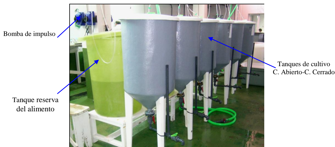
Figura 13.- Sistema de cultivo larvario en circuito abierto y circuito cerrado.
