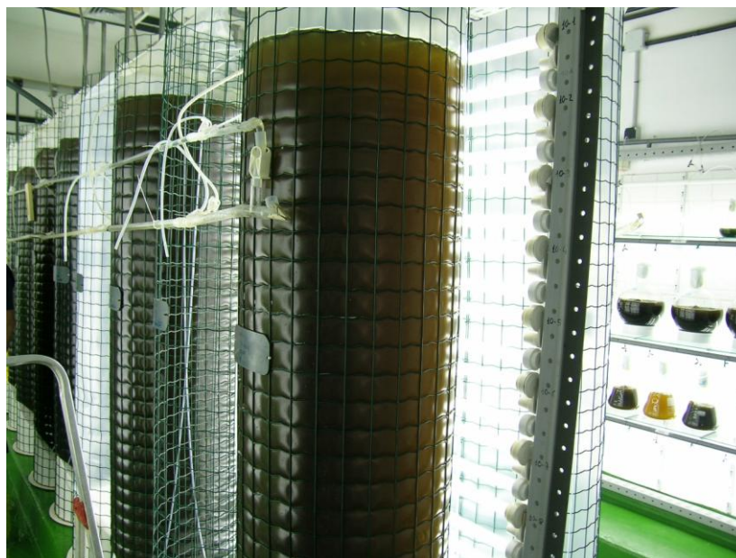
Figura 20.- Cámara de cultivo en matraces (2-6 L) y bolsas (200 L) en sistema continuo en el IFAPA de Andalucía.
