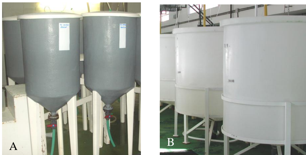
Figura 10.- Tanques troncocónicos (2.000 L) de polietileno blanco.
