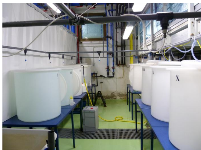
Figura 11.- Tanques troncocónicos (350 L) de polietileno blanco.
