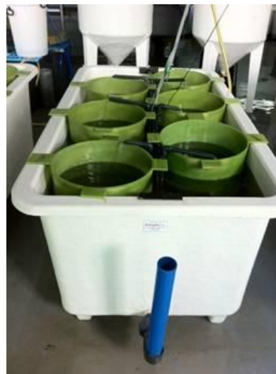
Figura 64.- Tanque de 1.000 L de preengorde de semilla en criadero.
