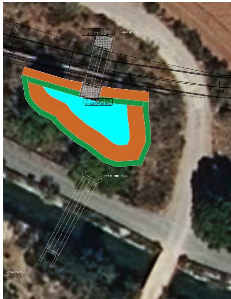
Figura 28.-Ejemplo de charca para anfibio y sifón bajo conducción principal, dando continuidad a la obra de drenaje transversal bajo el canal de Peñarroya.
