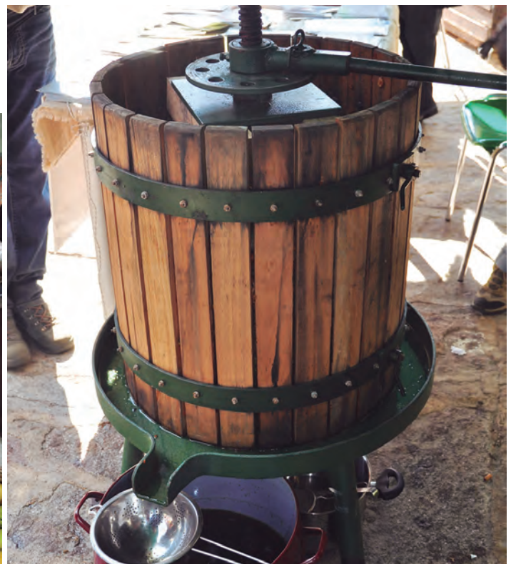
Trituradora y prensa artesanal moderna para hacer zumo de manzana y sidra de forma casera. Laura Aceituno-Mata
