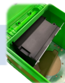
PRIMER PROTOTIPO DE ENVOLVENTE A ESCALA REAL. NUEVA DEFINICIÓN DE BISAGRAS PARA MEJOR EXTRACCIÓN DE REMOTAS.
