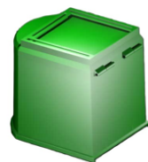
PRIMER DISEÑO CAD DE LA ENVOLVENTE. TAPA SUPERIOR ABATIBLE CON ALOJAMIENTO PARA EL PANEL FOTOVOLTAICO
