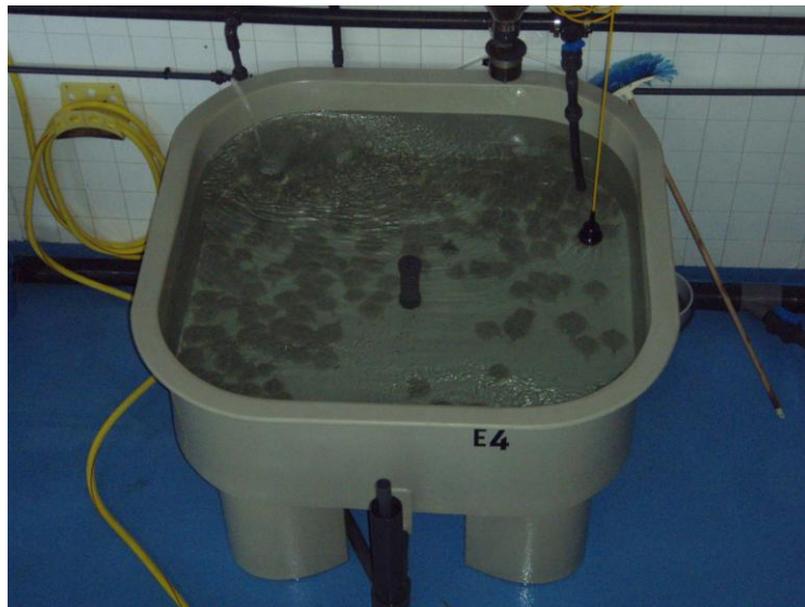
Foto 4: Tanque de cultivo en circuito cerrado.
