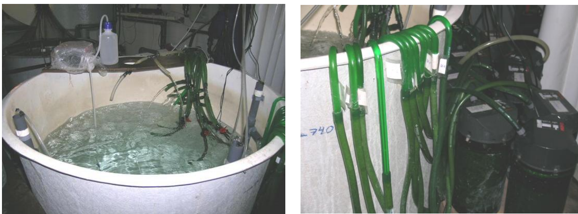
Figura 12. Detalles del tanque de 700 l y los filtros empleados para la determinación de la eficacia de distintos sustratos comerciales.
