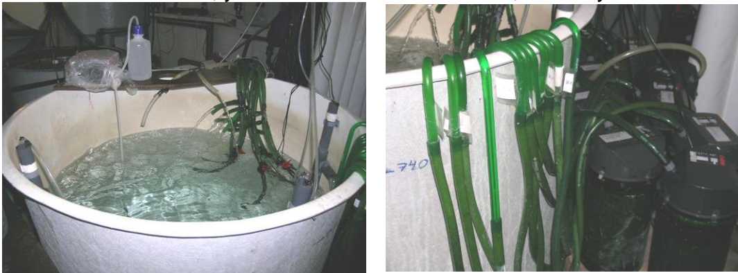
Detalles del tanque de 700 l y los filtros empleados para la determinación de la eficacia de distintos sustratos comerciales
