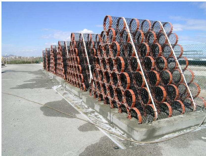
Figura 2: Biofiltros bentónicos y sistema de fondeo específico de la CA Murcia (Fuente IMIDA).
